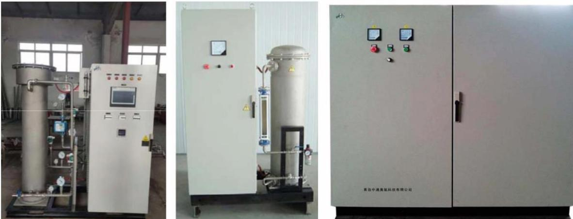
中型臭氧发生器分类有空气源型和氧气源型。采用制氧机式的板式和PSA富氧（干燥）机的管式，具有自主知识产权设计制造，气源处理好，管式为电晕放电，不锈钢电极，玻璃介质；板式为间隙放电，铝电极，进口陶瓷板介质，模具加工，精度高，放电间隙小（ $<0.3\text{mm}$ ）且一致性高；产量、浓度高，性能稳定，运行质量可靠，解决了一般臭氧发生器常见故障，大大提高了设备使用寿命。
